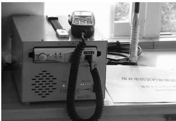
避難所となる市内小中学校等に整備されている防災行政無線
