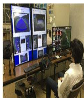
遠隔監視・操作装置の配置例 (右：遠隔操作モニタ)
