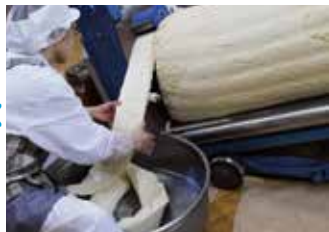
③板切作業1 生地を麺圧機で加圧しながら回転させ、10cmほどの麺帯に切っていく。
