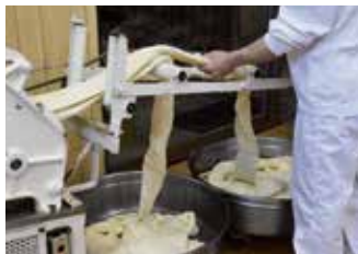
④板切作業2 ローラーにかけて加圧を繰り返す、徐々に厚みを押さえて薄く丸くしていく。
