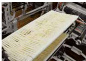
⑦掛巻作業 麺紐の細さを調整しながら「より」を掛け、2本の棒に8の字にかけていく。
