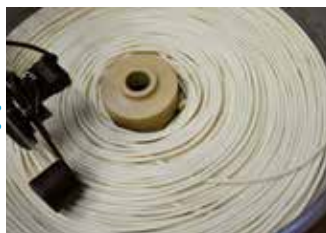
⑥細め（小より）作業 巻き入れ機で細め（10mm）から小より（5mm）に熟成を繰り返す、順に巻いていく。
