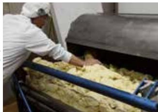
②圧延作業 麺圧機に移して回転させ、圧力をかけながら生地を整えていく。
