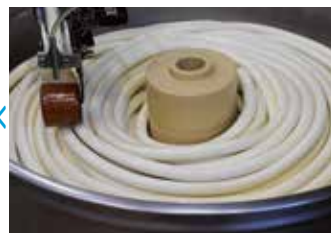
⑤油返し作業 専用の素麺油を塗布し、「より」を掛けながら細く巻き入られていく。
