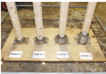
▲ 試行錯誤中の「令和の掘立柱工法」
