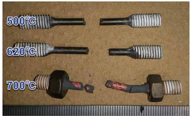
図4 青銅試料サンプルの高温引張試験結果と試験後の試料片外観
